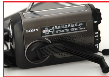
このラジオには、手回し充電用のハンドルその他、上部には太陽電池も搭載。
